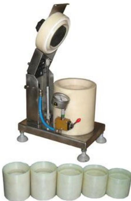
**Описание:** На данном оборудовании осуществляется укупорка крышками типа «Твист-Офф» стеклянных банок емкостью до 1000 мл, соответствующих по размерам и по форме ГОСТ 5717.2-2003. Вакуумная укупорка банок «Твист-Офф» происходит после предварительной
