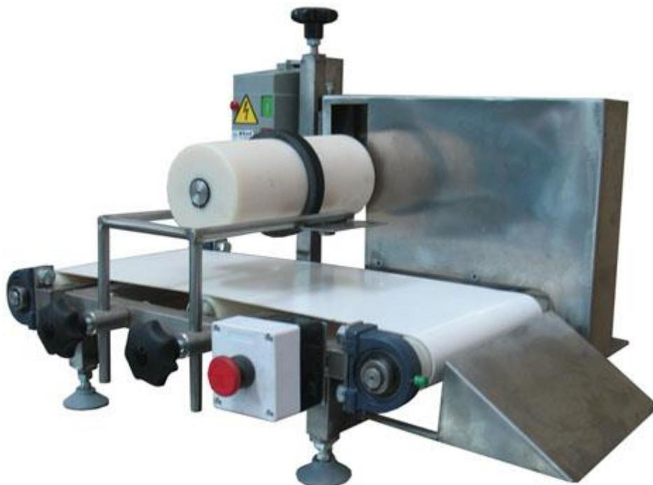
**Описание:** Данное оборудование предназначено для герметичного укупоривания крышкой полимерной тары, заполненной продуктом и/или заливкой; обеспечивает качественное укупоривание тары с частичным вытеснением воздуха; легко настраивается на закрывание плоской тары различной формы, имеющей высоту от 60 до 110 мм. Данный укупорщик крышек изготовлен из пищевой нержавеющей стали и выполнен в настольном варианте.
