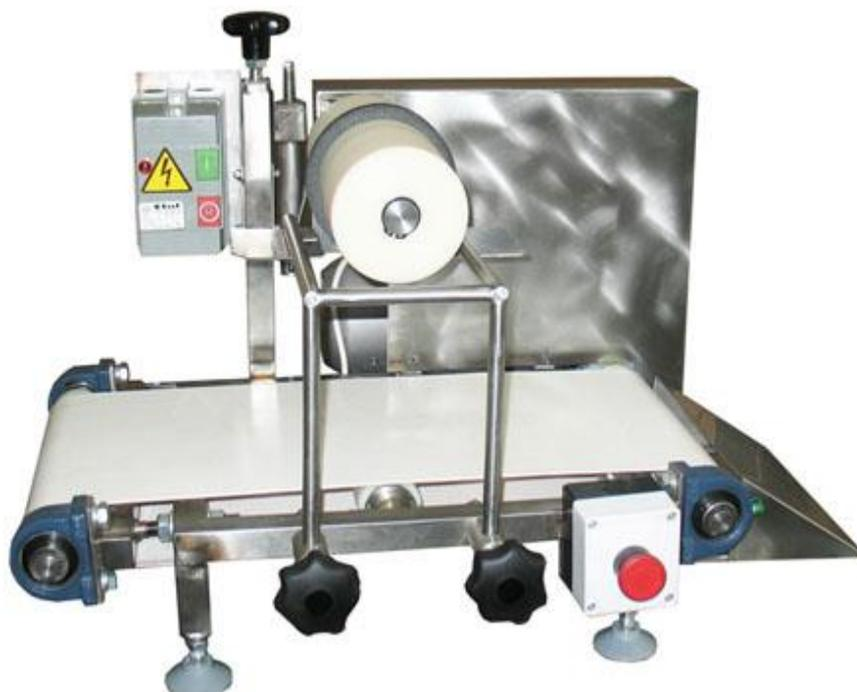
**Описание:** Данное оборудование предназначено для герметичного закрывания крышкой полимерной тары, заполненной продуктом и/или заливкой; обеспечивает качественное укупоривание тары с частичным вытеснением воздуха; легко настраивается на закрывание плоской тары различной формы, имеющей высоту от 110 до 160 мм. Укупорщик изготовлен из пищевой нержавеющей стали и выполнен в настольном варианте.
