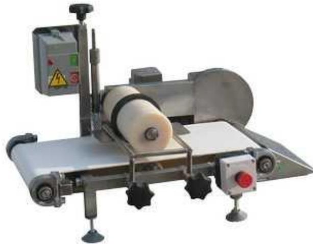
**Описание:** Данное оборудование предназначено для герметичного закрывания крышкой полимерной тары, заполненной продуктом и/или заливкой; обеспечивает качественное укупоривание тары с частичным вытеснением воздуха; легко настраивается на закрывание плоской тары различной формы, имеющей высоту от 15 до 60 мм.
