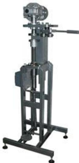
**Описание:** Данное оборудование предназначено для закатывания крышек жестяных банок, выполненных по ГОСТ 5981-88 цилиндрической формы с внутренним диаметром 83,4мм: № 38, 5, 6 и внутренним диаметром 99 мм: № 21, 2, 3, 8, 11, 12, 13 с высотой банок от 23,5 до 124 мм. Заказ дополнительных комплектов обеспечивает возможность работы с банками остальных типоразмеров:
