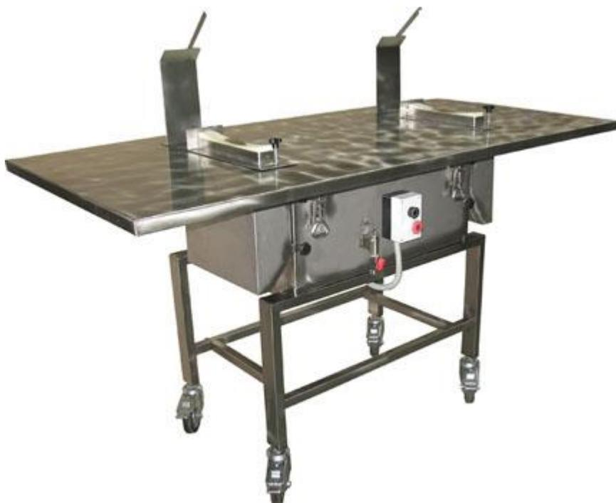
Описание: Данное оборудование предназначено для разделки крабов - твёрдых частей тушек (панцирей), а также клешней на предприятиях пищевой промышленности. Машина разделки крабов выполнена из пищевой нержавеющей стали.
