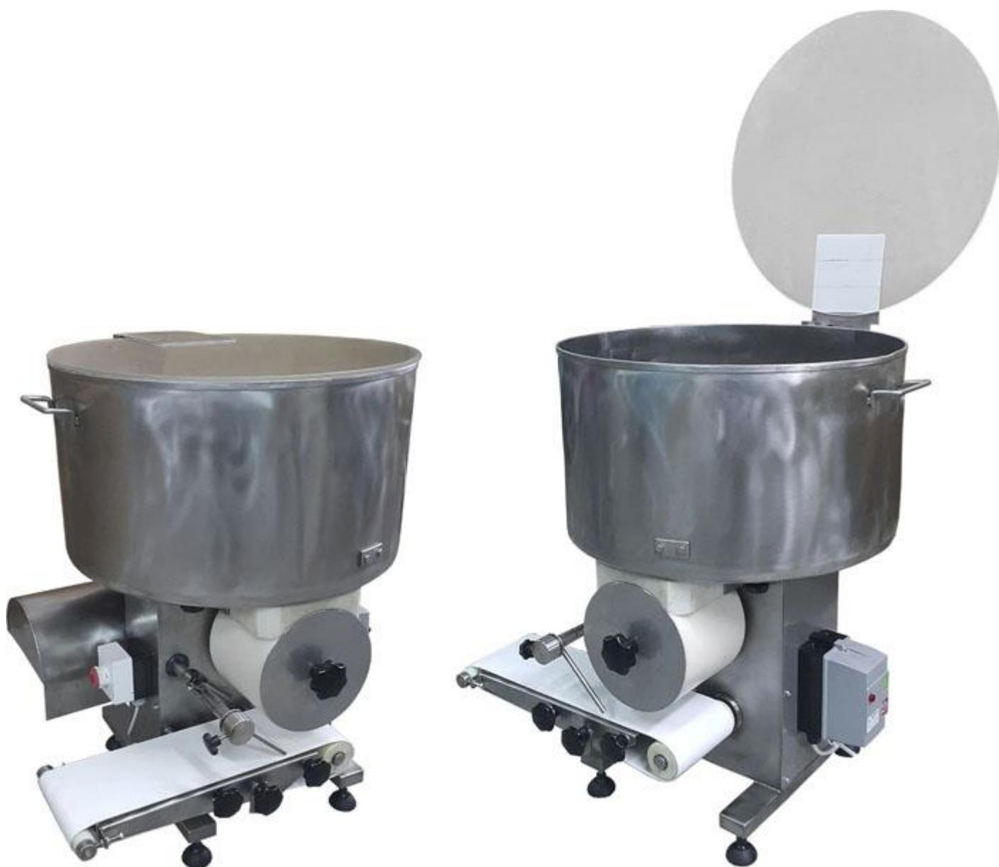
Описание: Данное оборудование предназначено для производства (формования) заготовок гамбургеров и других полуфабрикатов плоской формы. Автомат для производства гамбургеров имеет формующее устройство барабанного типа и ленточный отводящий транспортер, что позволяет, обеспечивая высокую производительность, с малой погрешностью регулировать массу заготовок гамбургеров различного диаметра. Имеет компактное настольное исполнение, может работать на мясном, рыбном и овощном фаршах.
