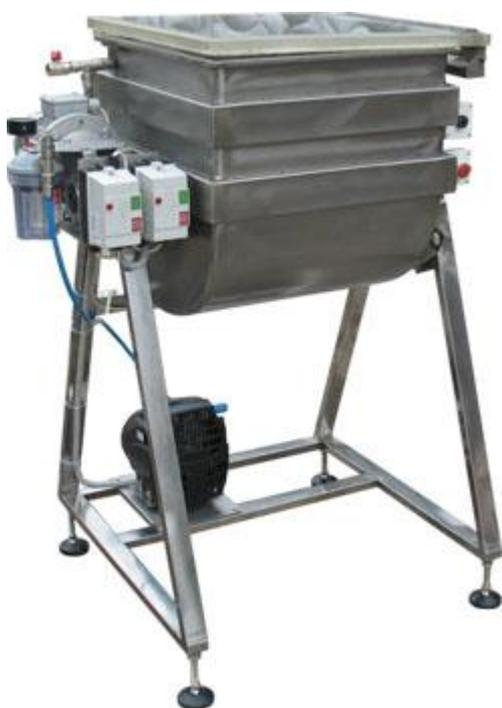
Описание: Предназначена для перемешивания мясного фарша и других измельченных пищевых продуктов в условиях вакуума; имеет вымешивающее устройство лопастного типа,
