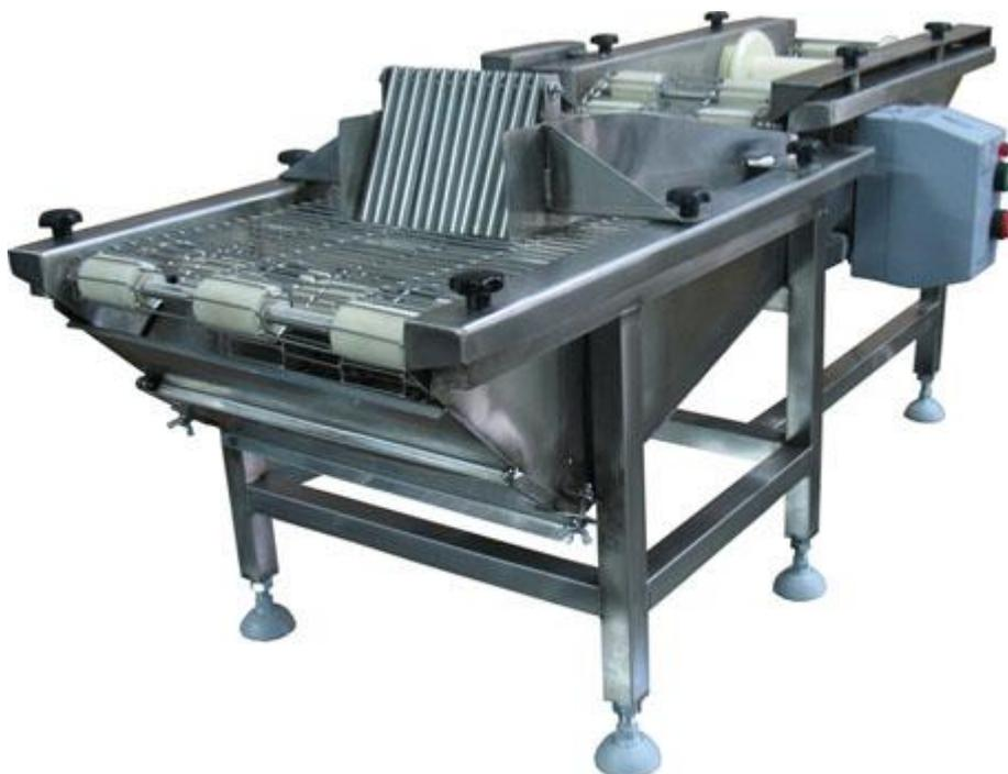
Описание: Машина панировочная предназначена для глазировании в льезоне и автоматической обсыпки панировочными сухарями полуфабрикатов из мясного, рыбного или овощного фарша. Для перемещения полуфабрикатов в ванне с льезоном и в коробе с панировочными сухарями установлены транспортеры с лентой из пищевой нержавеющей стали.
