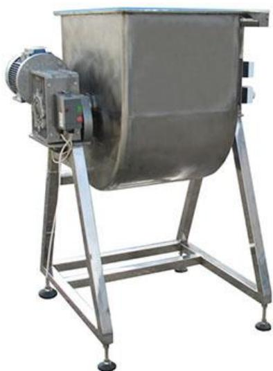
Описание: Предназначена для перемешивания мясного фарша и других измельченных пищевых продуктов; имеет вымешивающее устройство лопастного типа, обеспечивающее равномерное перемешивание продукта.
