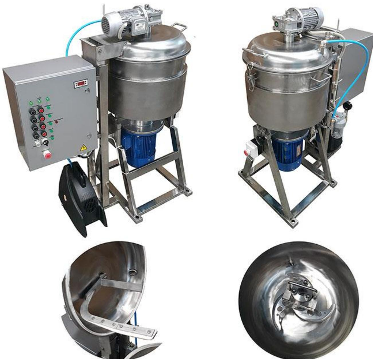
Описание: Данное оборудование предназначено для производства мясного или рыбного фарша в условиях вакуума, используемого при производстве колбасных изделий, паштетов ипельменей. Промышленный вакуумный куттер может быть эффективно использован как куттер-измельчитель для измельчения мяса, для измельчения и смешивания охлажденных овощей, бескостного фруктового, рыбного сырья, приготовления кондитерской, ореховой пасты, пюре и других продуктов, а также как куттер-миксер для приготовления майонезных
