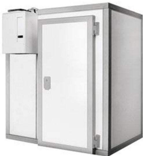
Описание: Данное оборудование предназначено для хранения при низких (-20...-15 °С) температурах предварительно охлажденного пищевого сырья или готовых продуктов. Камера холодильная низкотемпературная собрана из пенополиуретановых панелей с теплоизолирующим слоем толщиной 100 мм; облицовка панелей с обеих сторон имеет стойкое полимерное покрытие. Оснащена моноблочным холодильным агрегатом марки Polair MB, обеспечивающим низкотемпературный режим хранения. Отличительными
