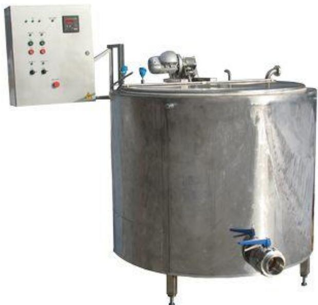
**Описание:** Данное оборудование предназначено для пастеризации молока, сливок и других жидкых продуктов, а также для проведения процессов сквашивания, обработки творожного и сырного сгустков, смешивания многокомпонентных составов в пищевой, химической и парфюмерно-косметической промышленностях. Для удобства потребителя выпускается
