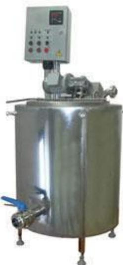
Описание: Ванна длительной пастеризации молока (ВДП) предназначена для пастеризации молока, сливок и других жидкых продуктов, а также для проведения процессов сквашивания, обработки творожного и сырного сгустков, смешивания многокомпонентных составов в пищевой, химической и парфюмерно-косметической промышленностях.
