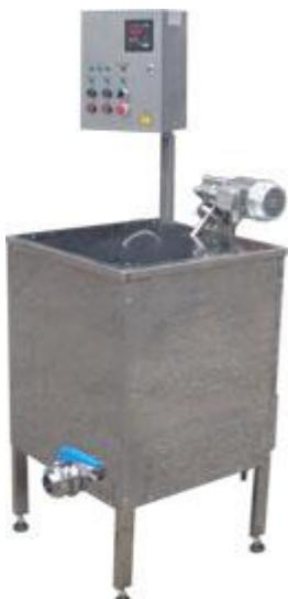
Описание: Ванна длительной пастеризации молока (ВДП) предназначена для подогрева или пастеризации молока и сливок, приготовления кисломолочных продуктов, для получения и обработки творожного и сырного сгустков, а также для приготовления многокомпонентных смесей в пищевой, химической и парфюмерно-косметической промышленностях.
