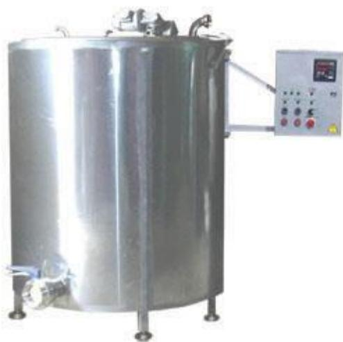
Описание: Данное оборудование предназначено для пастеризации молока, сливок и других жидких продуктов, а также для проведения процессов сквашивания, обработки творожного и сырного сгустков, смешивания многокомпонентных составов в пищевой, химической и
