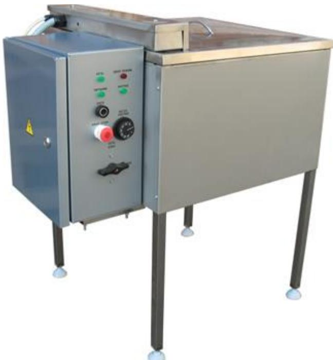
**Описание:** Данное оборудование предназначено для тепловой обработки (бланширования, варки) плодоовощной, мясной и рыбной продукции. Для удобства работы может оснащаться сетчатыми корзинами ИПКС-073-04(Н) (емкостью 14 литров) и приставкой ИПКС-073-07(Н), на которую для стекания и сбора жидкости могут быть установлены корзины с прошедшим термическую обработку продуктом.
