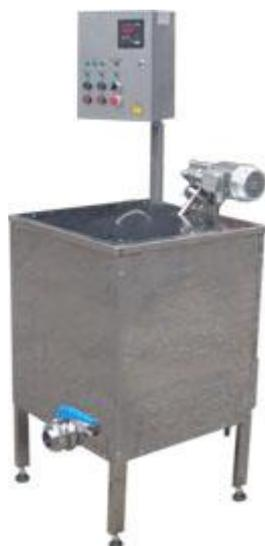
**Описание:** Ванна длительной пастеризации молока (ВДП) предназначена для подогрева или пастеризации молока и сливок, приготовления кисломолочных продуктов, для получения и обработки творожного и сырного сгустков, а также для приготовления многокомпонентных смесей в пищевой, химической и парфюмерно-косметической промышленности.
