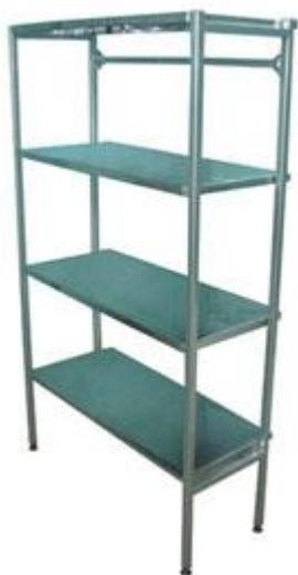
Описание: Стеллаж нержавеющей предназначен для использования на предприятиях общественного питания и пищевой промышленности. Изготовлен из пищевой нержавеющей стали, имеет разборную конструкцию, состоит из 4-х полок и каркаса. Каркас выполнен из трубы прямоугольного профиля размером 25x25, имеет уголки для крепления к стене и регулируемые по высоте опоры.
