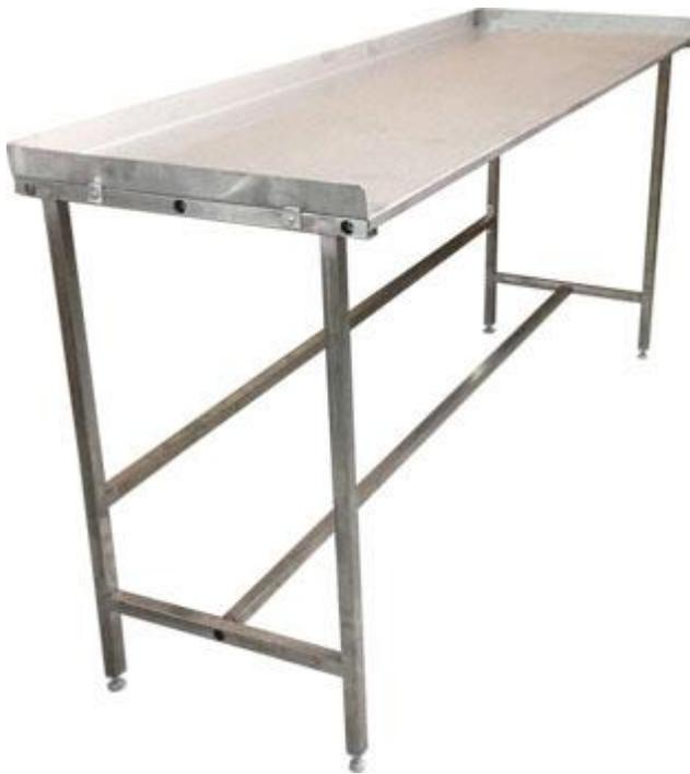
Описание: Стол нержавеющей обвалочный предназначен для разнообразных технологических операций с пищевыми продуктами на предприятиях общественного питания и пищевой промышленности. Имеет разборную конструкцию, состоит из столешницы с тремя бортами высотой 40 мм и каркаса. Каркас выполнен из трубы прямоугольного профиля размером 25x25 мм, имеет специальные стяжки для повышения жесткости и регулируемые по высоте опоры. Выполнен из пищевой нержавеющей стали.
