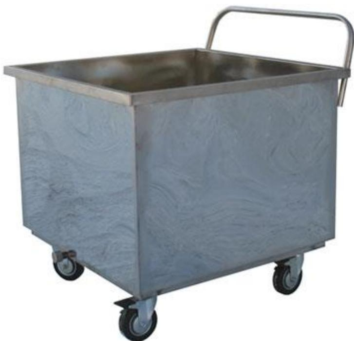
Описание: Предназначена для засолки и транспортировки мясных, рыбных и иных продуктов на предприятиях перерабатывающей и пищевой промышленности; тележка оснащена ручкой, 4-мя поворотными колесными опорами (диаметром 100 мм) со стопором и сливным патрубком диаметром 20 мм с заглушкой. Выполнена из пищевой нержавеющей стали.
