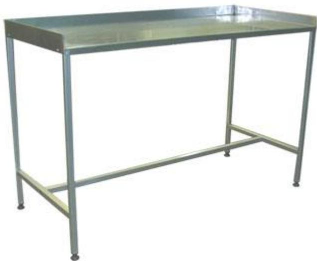
Описание: Стол нержавеющий обвалочный предназначен для разнообразных технологических операций с пищевыми продуктами на предприятиях общественного питания и пищевой промышленности. Имеет разборную конструкцию, состоит из столешницы с тремя бортами высотой 40 мм и каркаса. Каркас выполнен из трубы прямоугольного профиля размером 25x25 мм, имеет специальные стяжки для повышения жесткости и регулируемые по высоте опоры. Выполнен из пищевой нержавеющей стали.
