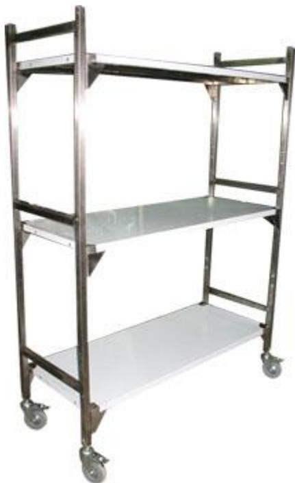
Описание: Стеллаж нержавеющей предназначен для хранения крупногабаритного инвентаря или посуды на предприятиях общественного питания. Стеллаж изготовлен из пищевой нержавеющей стали, имеет разборную конструкцию, состоит из 3-х полок и каркаса на колесных опорах со стопором. Каркас выполнен из трубы прямоугольного профиля размером 25x25.
