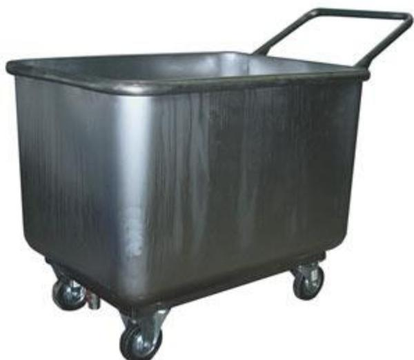
Описание: Предназначена для перевозки творога и иных продуктов на предприятиях пищевой промышленности. Тележка представляет собой цельнотянутую ванну прямоугольной формы емкостью 150 л, закрепленную на несущей раме. В дне ванны имеется сливной патрубок с краном диаметром проходного отверстия 15 мм. Для удобства транспортировки тележка оснащена откидной ручкой и четырьмя поворотными колесными опорами с тормозом. Выполнена из пищевой нержавеющей стали.
