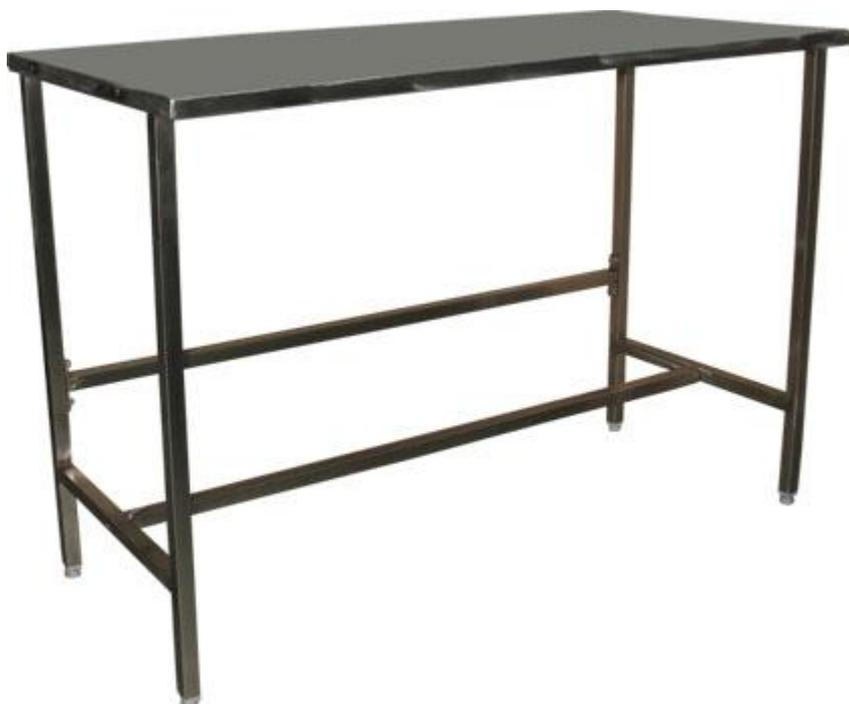
Описание: Стол нержавеющий островной предназначен для разнообразных технологических операций с пищевыми продуктами на предприятиях общественного питания и пищевой промышленности. Имеет разборную конструкцию, состоит из столешницы и каркаса. Каркас выполнен из трубы прямоугольного профиля размером 25x25 мм, имеет специальные стяжки для повышения жесткости и регулируемые по высоте опоры. Выполнен из пищевой нержавеющей стали.
