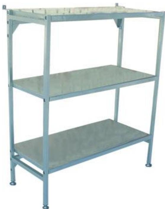
Описание: Стеллаж нержавеющей предназначен для хранения крупногабаритного инвентаря или посуды на предприятиях общественного питания. Изготовлен из пищевой нержавеющей стали, имеет разборную конструкцию, состоит из 3-х полок и каркаса. Каркас выполнен из трубы прямоугольного профиля размером 25x25, имеет уголки для крепления к стене и регулируемые по высоте опоры. Возможно изготовление стеллажа на колесных опорах (модель ИПКС-115-1,2НК(Н)).
