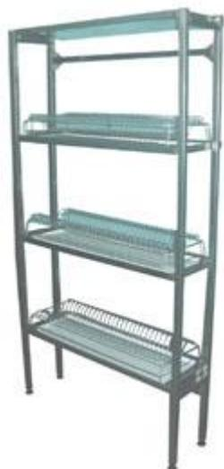
Описание: Стеллаж нержавеющей предназначен для сушки посуды и инвентаря на предприятиях общественного питания. Стеллаж имеет разборную конструкцию, состоит из 4-х полок и каркаса, укомплектован решетками для сушки посуды и инвентаря и поддонами для сбора жидкости. Каркас стеллажа выполнен из трубы прямоугольного профиля размером 25x25 мм, имеет уголки для крепления к стене и регулируемые по высоте опоры. Выполнен из пищевой нержавеющей стали.
