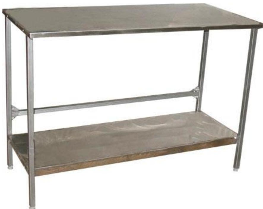
Описание: Стол нержавеющей островной с полкой предназначен для разнообразных технологических операций с пищевыми продуктами на предприятиях общественного питания и пищевой промышленности. Имеет разборную конструкцию, состоит из столешницы, каркаса и нижней полки для размещения инвентаря. Каркас выполнен из трубы прямоугольного профиля размером 25x25 мм, имеет специальные стяжки для повышения жесткости и регулируемые по высоте опоры. Выполнен из пищевой нержавеющей стали.
