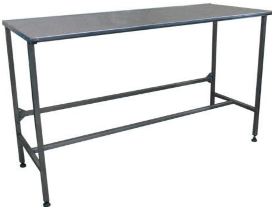
Описание: Стол нержавеющий островной предназначен для разнообразных технологических операций с пищевыми продуктами на предприятиях общественного питания и пищевой промышленности. Имеет разборную конструкцию, состоит из столешницы и каркаса. Каркас выполнен из трубы прямоугольного профиля размером 25x25 мм, имеет специальные стяжки для повышения жесткости и регулируемые по высоте опоры. Выполнен из пищевой нержавеющей стали.
