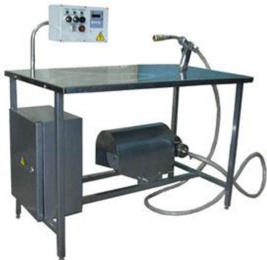
Описание: Данное оборудование предназначено для розлива жидких и вязких продуктов в различную тару (канистры, банки, бутылки, лотки и т.п.), размещаемую на рабочем столе. Аппарат розлива жидкостей оснащен блоком питания, пультом управления и импеллерным насосом, подающим продукт непосредственно из расходной емкости Заказчика на переносной "пистолетообразный" излив с клапаном.
