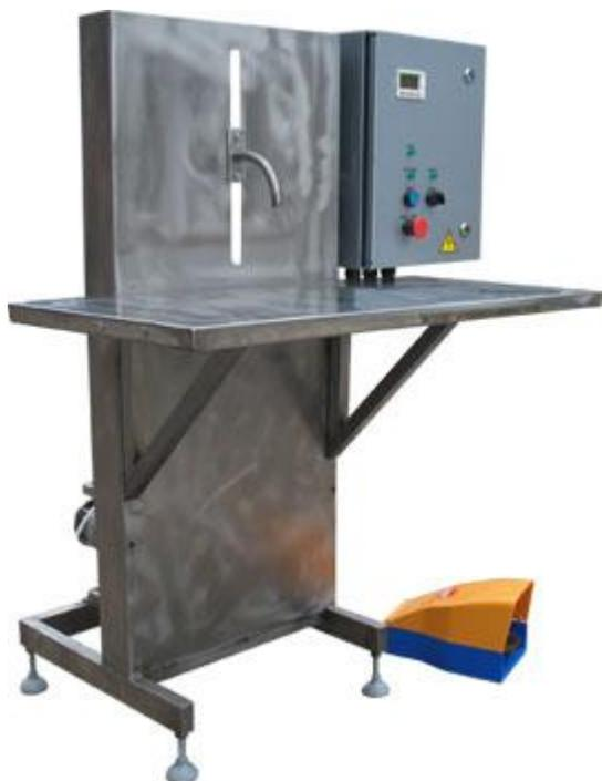
Описание: Данное оборудование предназначено для дозирования (розлива) в различную тару жидких и вязких продуктов с включениями. Дозатор жидкостей и вязких продуктов оснащен импеллерным насосом, подающим продукт на регулируемый по высоте излив непосредственно из расходной емкости Заказчика. Для удобства работы с различными фасуемым продуктами и разнообразной тарой предусмотрены два положения рабочего стола оператора и педальный привод для подачи дозы на излив.
