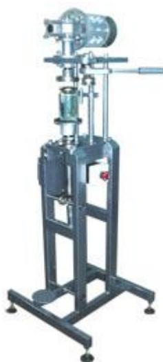
**Описание:** Данное оборудование предназначено для закатывания крышек стеклянных банок цилиндрической формы объемом 250, 350, 500, 650, 800, 1000 и 3000 мл (по ГОСТ 5717.2-2003), с внешним диаметром от 70 до 155 мм и высотой от 95 до 235 мм. На несущем каркасе установлен подъемный столик с педальным приводом, вращающийся упор для прижима крышки к банке во время укупорки, подвеска с ручным приводом обкатывающего ролика.
