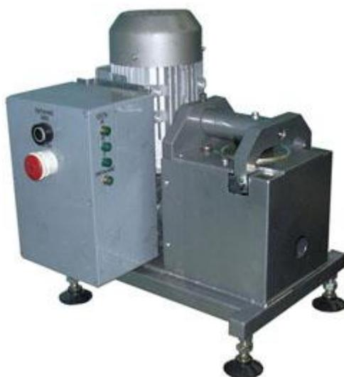
**Описание:** Данное оборудование предназначено для маркировки крышек толщиной 0,22 - 0,25 мм и диаметром от 60 до 110 мм, используемых для укупорки жестяных банок. Конструкция узла установки крышек на позицию клеймения позволяет легко и быстро настраиваться на крышки различного диаметра и позиционировать оттиск по центру крышки..
