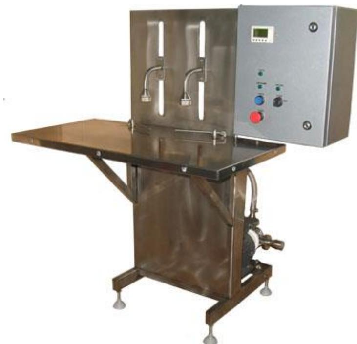
Описание: Предназначен для дозирования жидких и вязких продуктов в разнообразную по
