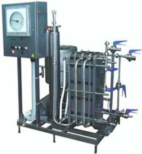
Описание: Предназначен для быстрого нагрева, кратковременной выдержки и последующего охлаждения молока, сливок, соков, питьевой воды и аналогичных по вязкости жидких продуктов; оснащен электронным блоком управления для автоматического поддержания, регулирования и контроля температуры пастеризации.
