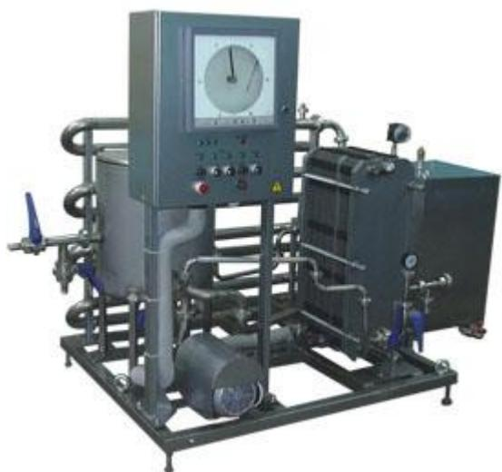
Описание: Пластинчатый пастеризатор-охладитель молока и жидких продуктов предназначен для быстрого нагрева, кратковременной выдержки и последующего охлаждения молока, сливок, соков, питьевой воды и аналогичных по вязкости жидких продуктов.
