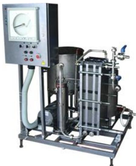
Описание: Пластинчатый пастеризатор-охладитель молока и жидких продуктов предназначен для быстрого нагрева, кратковременной выдержки и последующего охлаждения молока, сливок, соков питьевой воды и аналогичных по вязкости жидких продуктов; оснащен электронным блоком управления для автоматического поддержания, регулирования и контроля температуры пастеризации. Имеет закрытый контур нагрева, что обеспечивает работу пастеризатора без потери теплоносителя.
