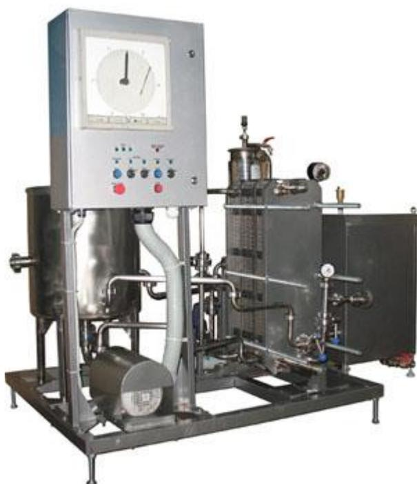
Описание: Пластинчатый пастеризатор-охладитель молока и жидких продуктов предназначен для быстрого нагрева, кратковременной выдержки и последующего охлаждения молока, сливок, соков, питьевой воды и аналогичных по вязкости жидких продуктов.
