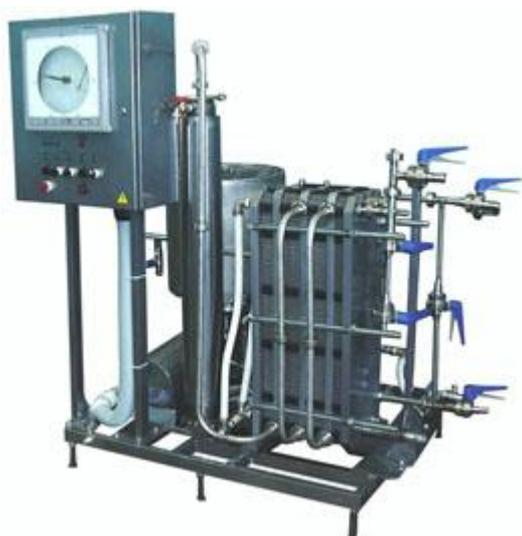
Описание: Пластинчатый пастеризатор-охладитель молока и жидких продуктов предназначен для быстрого нагрева, кратковременной выдержки и последующего охлаждения молока, сливок, соков, питьевой воды и аналогичных по вязкости жидких продуктов; оснащен электронным блоком управления для автоматического поддержания, регулирования и контроля температуры пастеризации.
