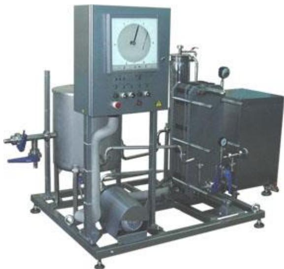
Описание: Пластинчатый пастеризатор-охладитель молока и жидких продуктов предназначен для быстрого нагрева, кратковременной выдержки и последующего охлаждения молока, сливок, соков, питьевой воды и аналогичных по вязкости жидких
