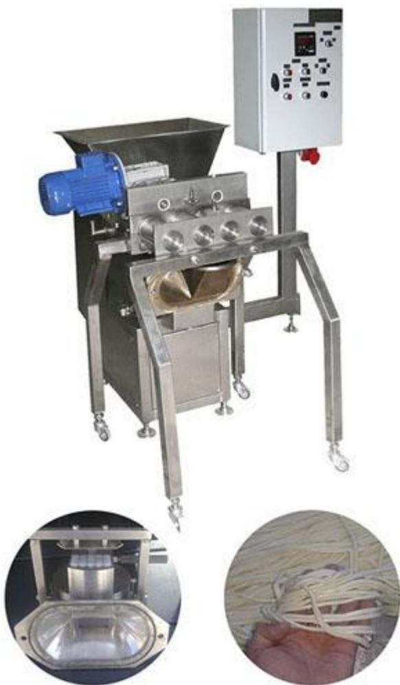
Описание: Данное оборудование предназначено для формования сыров группы "Паста Филата". Универсальный плавитель для формования сыров типа "Косичка", "Чечил", "Моцарелла", "Сулугуни" представляет собой шнековый механизм с увеличенной камерой (шнек, оправка, двигатель, редуктор, воронка, пульт управления с регулировкой скорости и температуры шнека. Предназначен для работы с подсоединяемыми формователями для сыров соответствующего типа:
