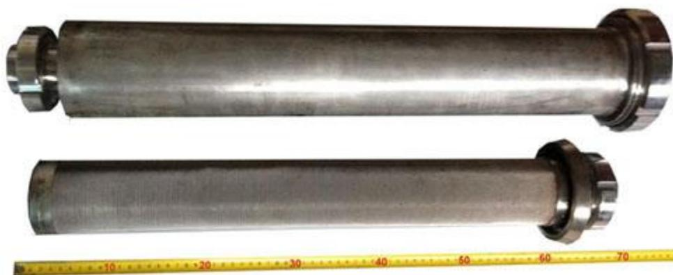
Описание: Предназначен для очистки молока на молокоперерабатывающих предприятиях и товарно-молочных фермах. Фильтр состоит из корпуса и установленного на фланце фильтрующего картриджа. Тонкость фильтрации определяется размером ячейки фильтрующей сетки (200 мкм), а пропускная способность (3, 6, 10, 15 или 25 тысяч литров/час) площадью сетки картриджа. Фильтр устанавливают непосредственно на молокопроводах и при циркуляционной мойке его очистка осуществляется противотоком
