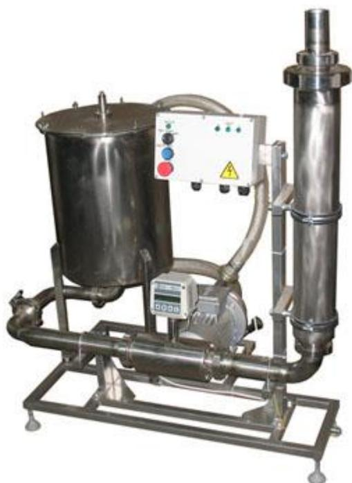
Описание: Данное оборудование предназначено для приема, учета и фильтрации молока в потоке. В состав комплекта входят центробежный насос ИПКС-017-ОНЦ-6,3/20(Н), герметичная емкость с поплавковым устройством для удаления воздуха из молока, электромагнитный счетчик молока, фильтр ИПКС-126-15-200(Н) с картриджем из нержавеющей сетки, комплект трубопроводов, общий пульт управления и единый несущий каркас. Выполнен из пищевой нержавеющей стали.
