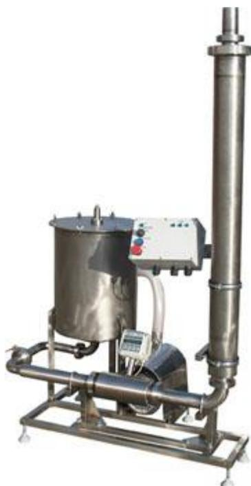
Описание: Данное оборудование предназначено для приемки, учета и фильтрации молока в потоке. В состав комплекта входят центробежный насос ИПКС-017-ОНЦ-6,3/20(Н), герметичная емкость с поплавковым устройством для удаления воздуха из молока, электромагнитный счетчик молока, фильтр ИПКС-126-25-200(Н) с картриджем из нержавеющей сетки, комплект трубопроводов, общий пульт управления и единый несущий каркас. Выполнен из пищевой нержавеющей стали.
