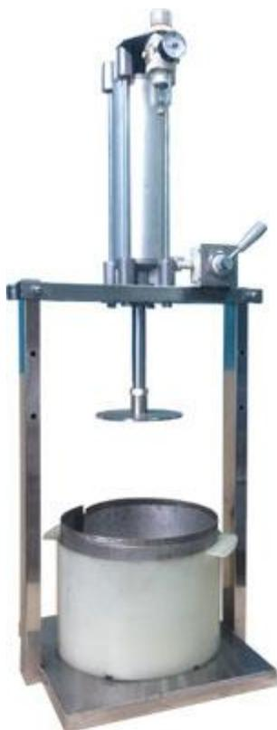
Описание: Пресс для сыра пневматический предназначен для прессования сырных головок в форме. Под действием сжатого воздуха, подаваемого на пресс, шток пневмоцилиндра с силой воздействует на форму с сыром, заставляя сыр уплотняться. Особенностью пневматического прессы является регулировка давления прессования за счет встроенного
