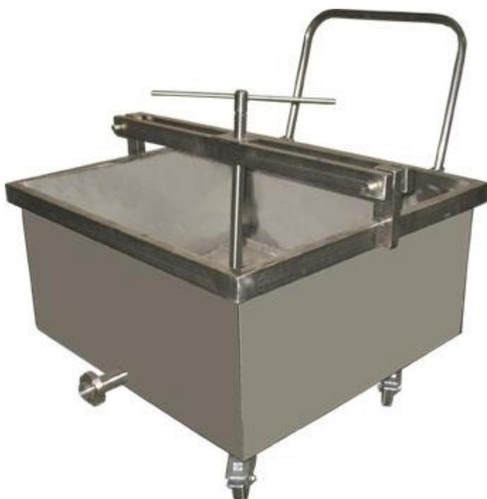
Описание: Данное оборудование применяется при производстве творога для самопрессования и механического прессования творожного сгустка, для образования и подпрессовки сырного пласта; а также для отделения жидкости из других продуктов.
