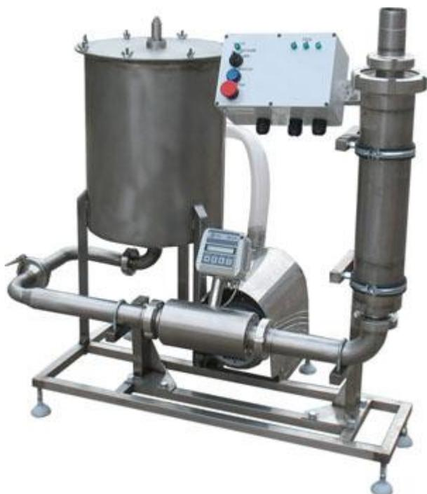
Описание: Данное оборудование предназначено для приёма, учета и фильтрации молока в потоке. В состав комплекта входят центробежный насос ИПКС-017-ОНЦ-6,3/20(Н), герметичная емкость с поплавковым устройством для удаления воздуха из молока, электромагнитный счетчик молока, фильтр ИПКС-126-6-200(Н) с картриджем из нержавеющей сетки, комплект трубопроводов, общий пульт управления и единый несущий каркас. Выполнен из пищевой нержавеющей стали.
