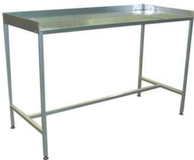
Описание: Стол нержавеющей обвалочный предназначен для разнообразных технологических операций с пищевыми продуктами на предприятиях общественного питания и пищевой промышленности. Имеет разборную конструкцию, состоит из столешницы с тремя бортами высотой 40 мм и каркаса. Каркас выполнен из трубы прямоугольного профиля размером 25x25 мм, имеет специальные стяжки для повышения жесткости и регулируемые по высоте опоры. Выполнен из пищевой нержавеющей стали.
