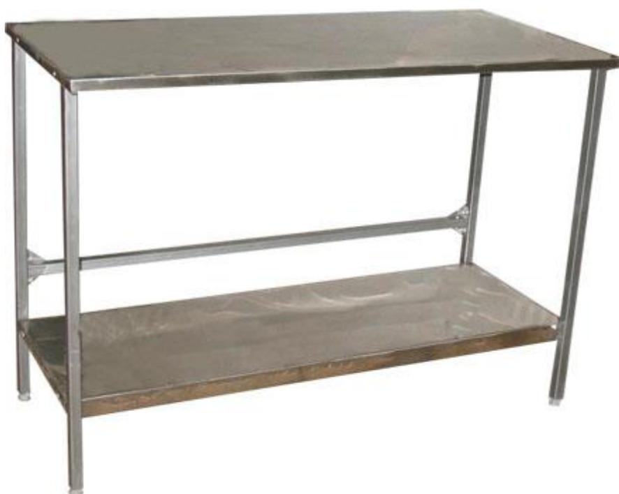
Описание: Стол нержавеющий островной с полкой предназначен для разнообразных технологических операций с пищевыми продуктами на предприятиях общественного питания и пищевой промышленности. Имеет разборную конструкцию, состоит из столешницы, каркаса и нижней полки для размещения инвентаря. Каркас выполнен из трубы прямоугольного профиля размером 25x25 мм, имеет специальные стяжки для повышения жесткости и регулируемые по высоте опоры. Выполнен из пищевой нержавеющей стали.
