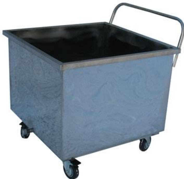
**Описание:** Предназначена для засолки и транспортировки мясных, рыбных и иных продуктов на предприятиях перерабатывающей и пищевой промышленности; тележка оснащена ручкой, 4-мя поворотными колесными опорами (диаметром 100 мм) со стопором и сливным патрубком диаметром 20 мм с заглушкой. Выполнена из пищевой нержавеющей стали.
