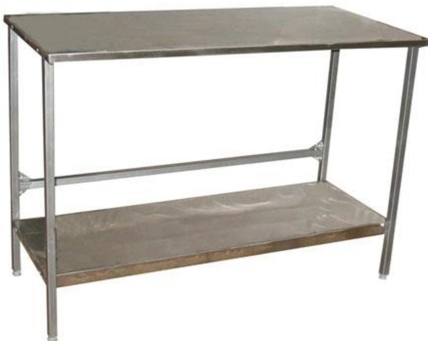
Описание: Стол нержавеющий островной предназначен для разнообразных технологических операций с пищевыми продуктами на предприятиях общественного питания и пищевой промышленности. Имеет разборную конструкцию, состоит из столешницы, каркаса и нижней полки для размещения инвентаря. Каркас выполнен из трубы прямоугольного профиля размером 25x25 мм, имеет специальные стяжки для повышения жесткости и регулируемые по высоте опоры. Выполнен из пищевой нержавеющей стали.
