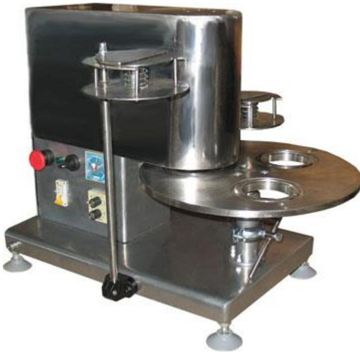
Описание: Предназначена для укупорки любых продуктов в стаканы из полистирола емкостью не более 0,5 л и размером горловины 75 и 95 мм. Укупорка стаканов осуществляется путем термической запайки горловины стаканов платинками из алюминиевой фольги.
