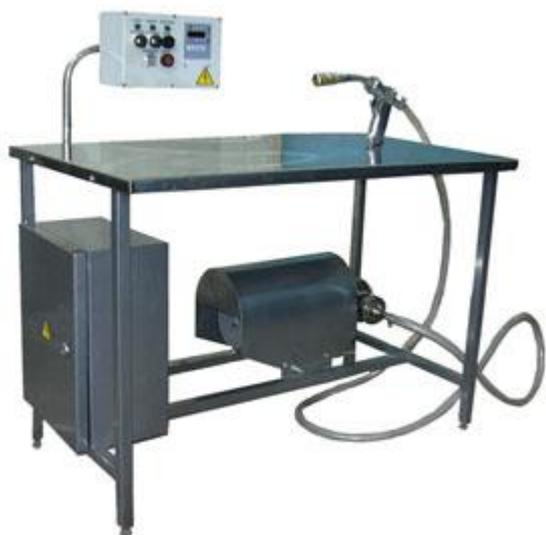
Описание: Данное оборудование предназначено для розлива жидких и вязких продуктов в различную тару (канистры, банки, бутылки, лотки и т.п.), размещаемую на рабочем столе. Аппарат розлива жидкостей оснащен блоком питания, пультом управления и импеллерным насосом, подающим продукт непосредственно из расходной емкости Заказчика на переносной "пистолетообразный" излив с клапаном.
