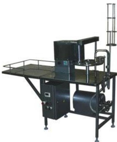
Описание: Предназначена для фасовки и укупорки жидких и вязких продуктов в стаканы из полистирола емкостью 0,15; 0,20; 0,25 и 0,5л и диаметром горловины 75 и 95мм. Укупорка
